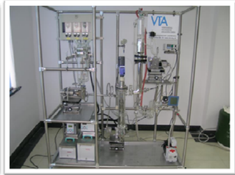
薄膜蒸発 (精留システム付き) 蒸発能力: 3kg/h 精留能力: 0.5kg~1kg/h
